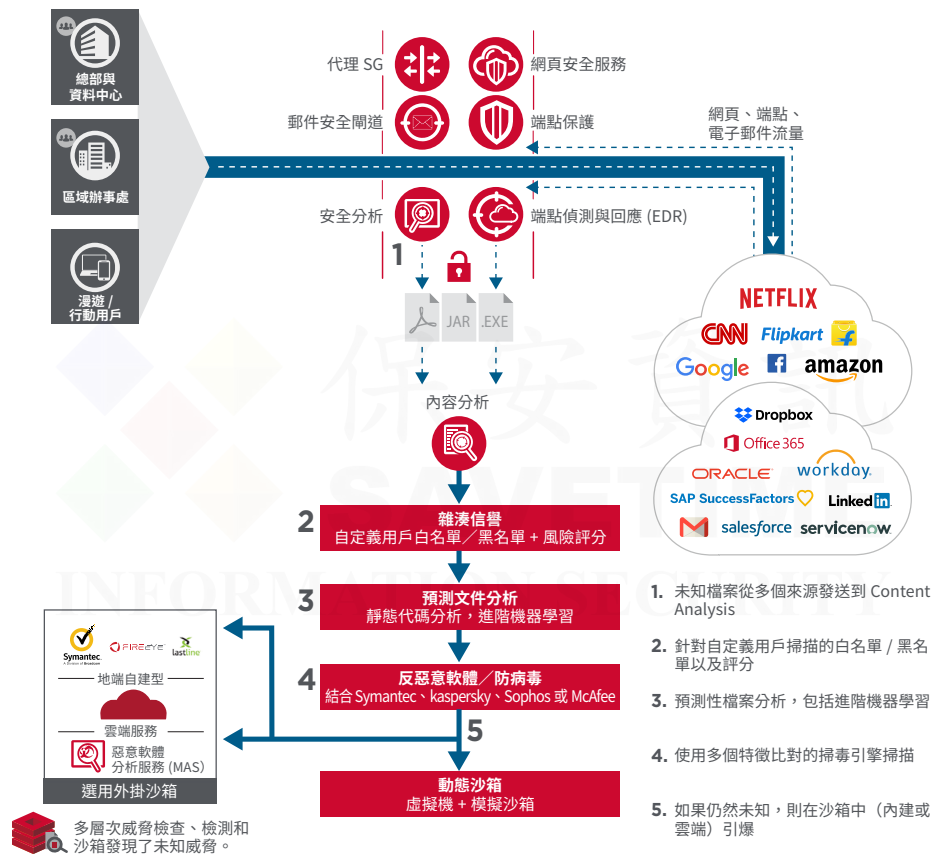
圖 1：在 ProxySG 仔細檢查 Web 流量之後，Content Analysis 將基於哈希信譽，進階機器學習來分析該流量中的所有檔案，然後使用雙防病毒軟體引擎掃描惡意軟體和病毒。所有剩餘的未知文件都將發送到動態沙箱。
